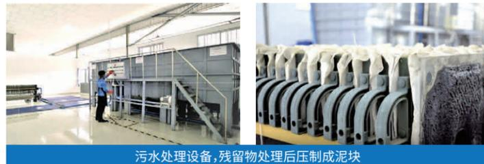
污水处理设备，残留物处理后压制成泥块
